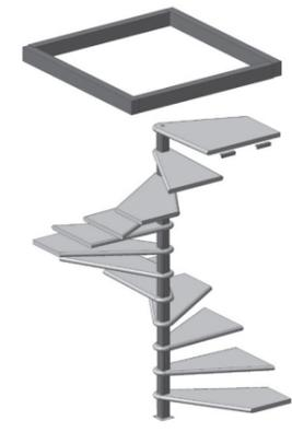
5. В углу первой ступени устанавливают столб № 1 (поз. 12, 1 шт.) На столбе для этого выбран соответствующий паз. Закрепляют столб двумя саморезами 3,5x70 мм.
